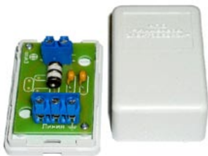
Рисунок 2. АЗУ-МЦ для установки в помещениях.
